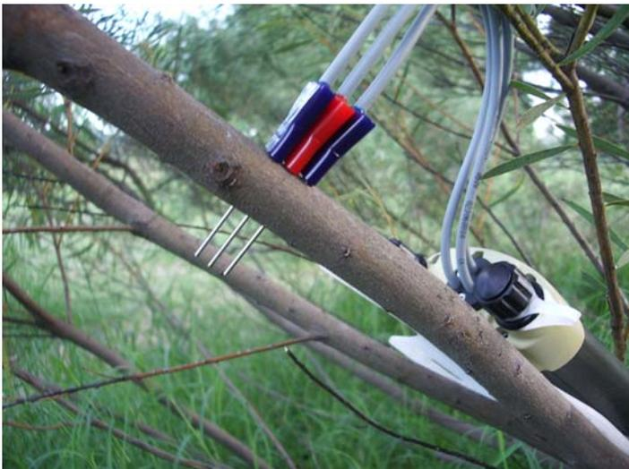
HRMの探針には二つの温度測定部があり、これにより幹・茎に対してラジアル方向に流れる樹液流勾配をより正確に測定でき、深さの異なる樹液流を観察できます。
